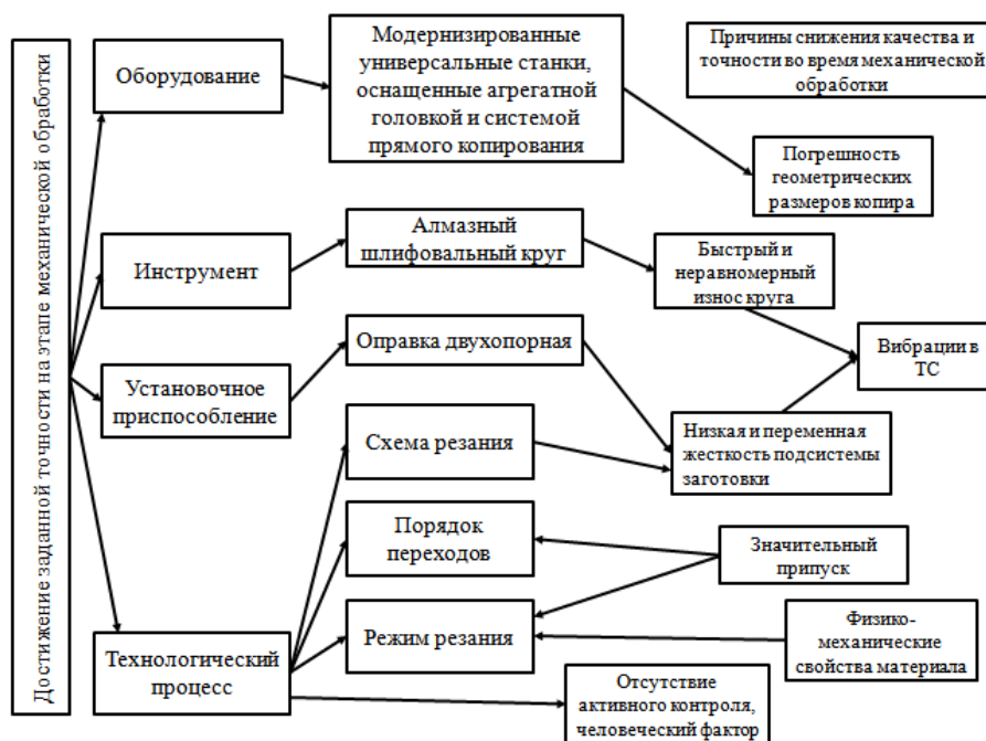
Рис. 2. Схема влияния элементов ТС на причины снижения качества поверхности и точности обработки оболочек из ситаллов на этапе алмазного шлифования
